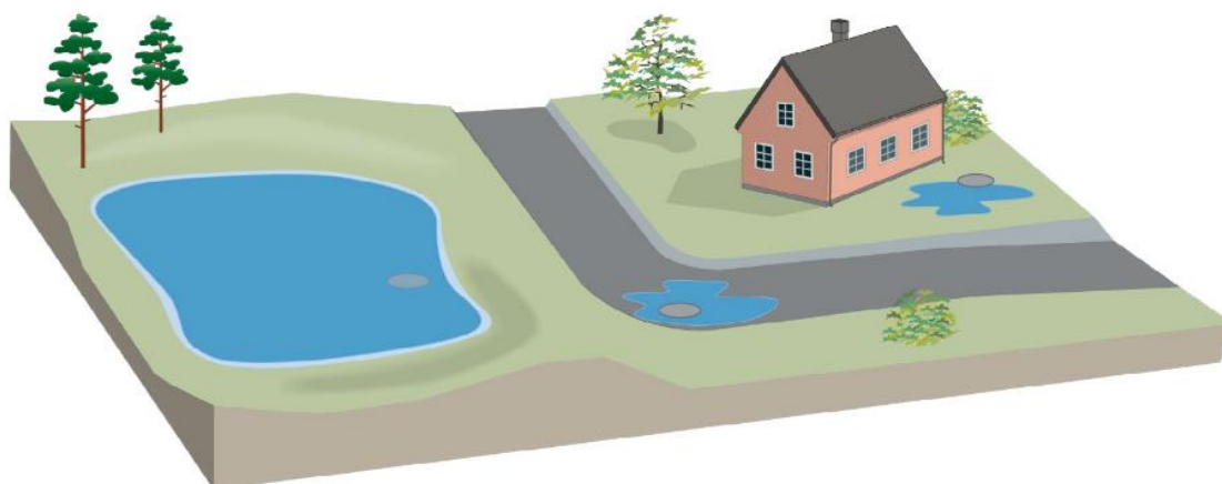
Figur 1. Illustrationsbild på förenklad skyfallskartering med statistiska verktyg. Lågpunkter i höjdmodellen fylls upp med applicerad regnvolym. Bild från Metod för skyfallskartering av tätorter, MSB (2023).
