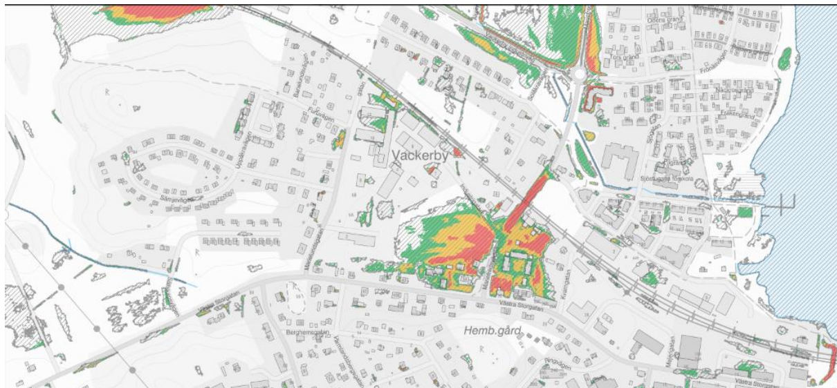
Figur 26. Illustration av konsekvenser vid nederbörd med varaktighet på minst 4 timmar. Skrafferad yta visar översvämningsutbredning.
