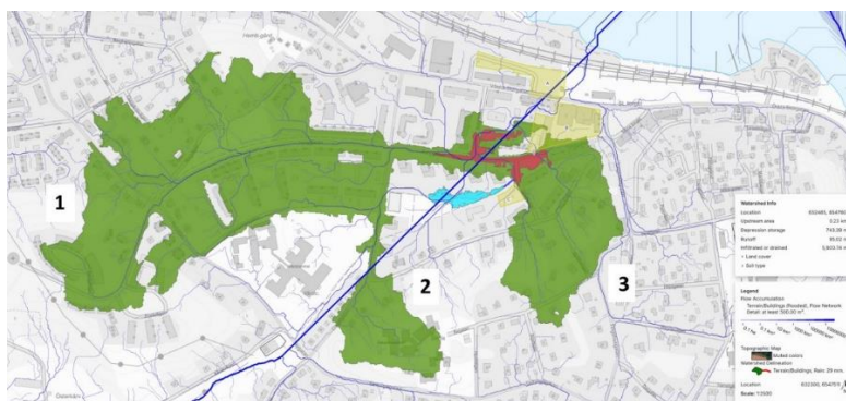
Figur 41. Bild från Scalgo med utfall för nederbörd om 29 mm regn. Redovisade avrinningsområden och rinnvägar som leder mot korsningen Torggatan/Marieströmsgatan
