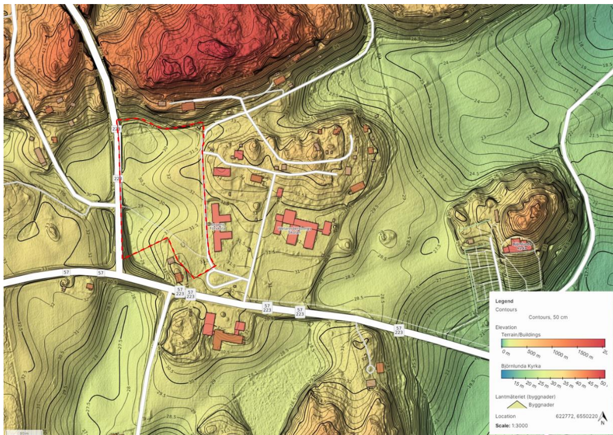
Figur 5. Topografi med nivåkurvor över planområdet, ScaloLive.
