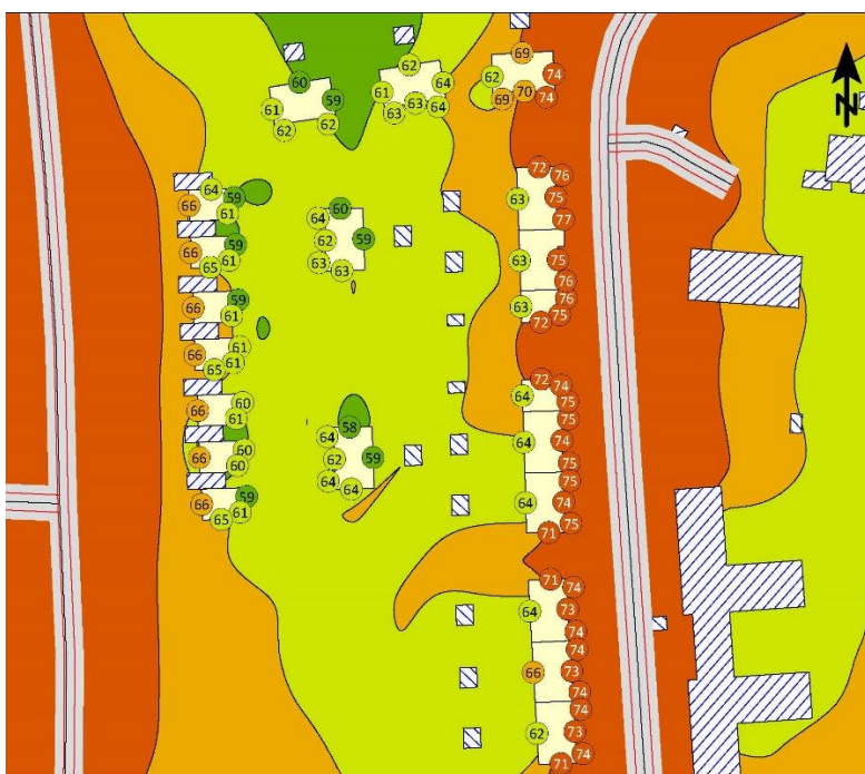
Bilden visar maximal ljudnivå på 2 meters höjd vid bostadsfasad med 2040 års trafiksituation vid byggandet av radhus/kedjehus.
